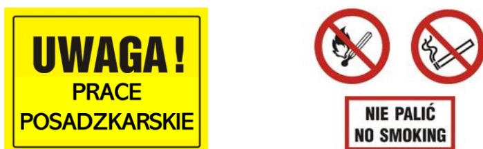
Rysunek 5 Oznakowanie pomieszczeń, w których prowadzone są prace z użyciem materiałów palnych lub o właściwościach wybuchowych
