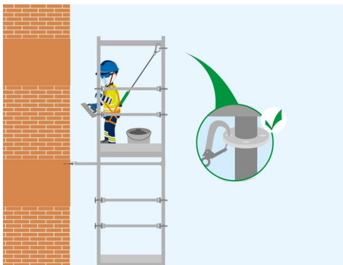
Rysunek 3 Przykładowe zabezpieczenie przed upadkiem z pomostu roboczego
